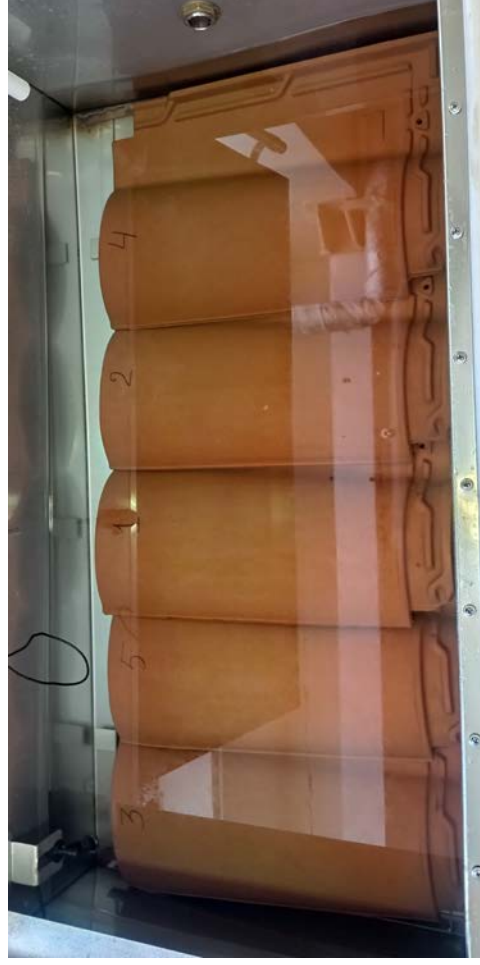
Рисунок - Образцы после 250 циклов попеременного замораживания и оттаивания
